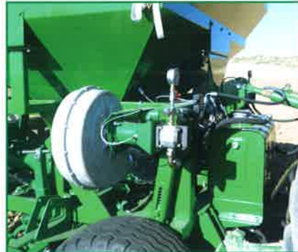
Ventiladores hidráulicos independientes.
