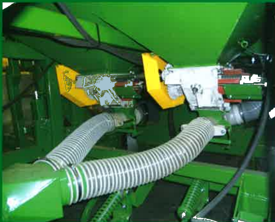
Distribuidor independiente para grano y abono. Independent doser for seed and fertilizer. Distributeur indépendant pour le grain et engrais.
