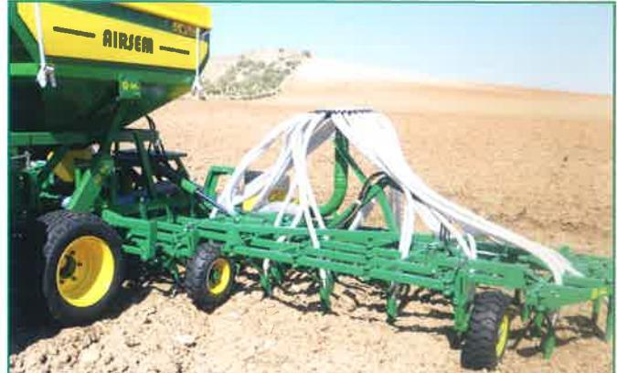
Sembradora con el tren de siembra flotante en 4 filas, consiguiendo la perfección en el control de profundidad.
