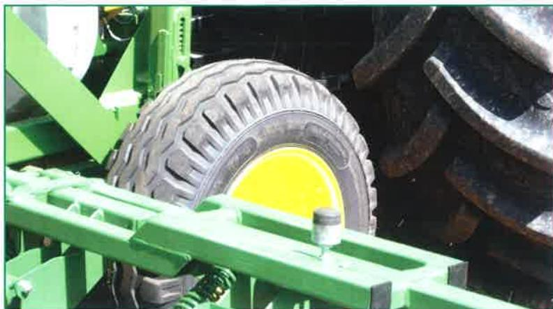
Las ruedas de tracción van situadas detrás de las ruedas del tractor lo que permite un movimiento suave y continuo al rodar sobre una superficie compactada lo que se traduce en una mejor distribución y en un perfecto control de la profundidad de siembra, ya que el peso de la semilla en la tolva no influye sobre ésta, aunque el terreno esté más o menos blando.
