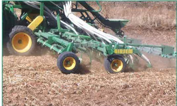
Presiembra independiente, situado entre las ruedas de tracción y el tren de siembra, lo que permite un borrado total y perfecto de todas las rodaduras, que unido a la tabla niveladora le proporciona una buena preparación de la cama de siembra.
