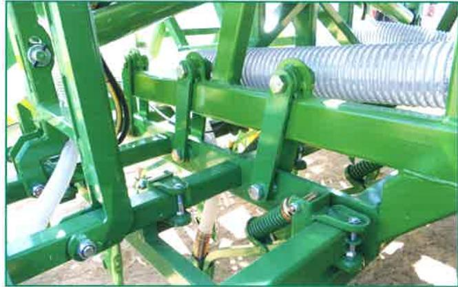
Tren de siembra colgado mediante paralelogramo. 4 ruedas de control del sistema de enterrado.
