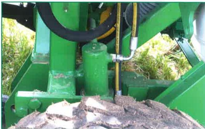
Sistema de control de la profundidad hidráulicamente.
