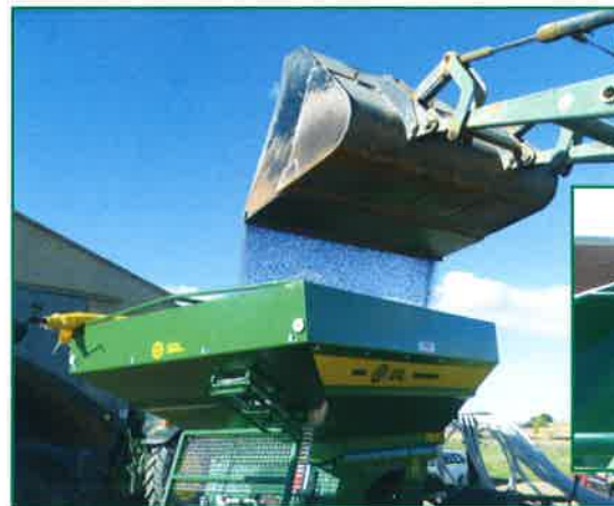
La tolva de 6.000 l. y la combinada de 3.650 l. de grano y 2.350 l. de abono, permite una cómoda y rápida carga con pala.
