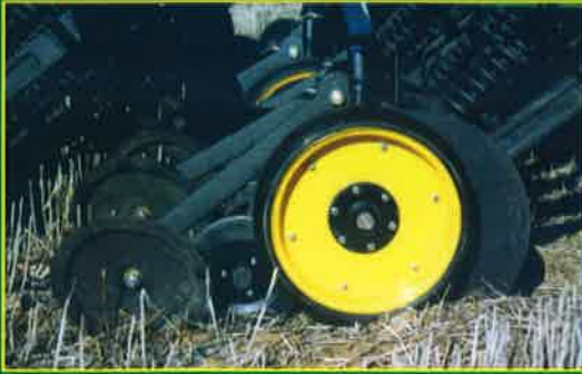
Elemento de siembra con rueda limitadora de profundidad, rueda compactadora y rueda tapadora.
