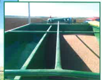
La tolva de 6.000 l. y la combinada de 3.650 l. de grano y 2.350 l. de abono, permite una cómoda y rápida carga con pala.
