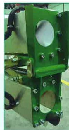
Barras en perfil de aluminio con articulaciones reforzadas y casquillos autolubricados.
