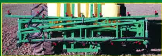
Barras manuales plegado libro de 10 y 12 m (portaboquillas simples o trijet).
