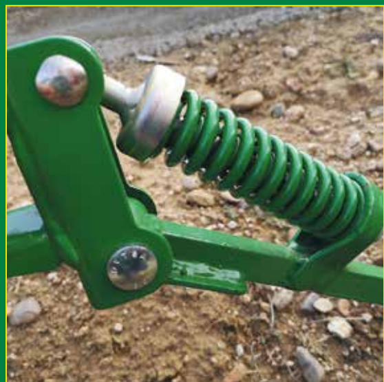
Brazo con doble muelle, para trabajo en condiciones más exigentes.
