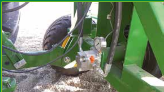
Opcionalmente ventilador hidráulico.
