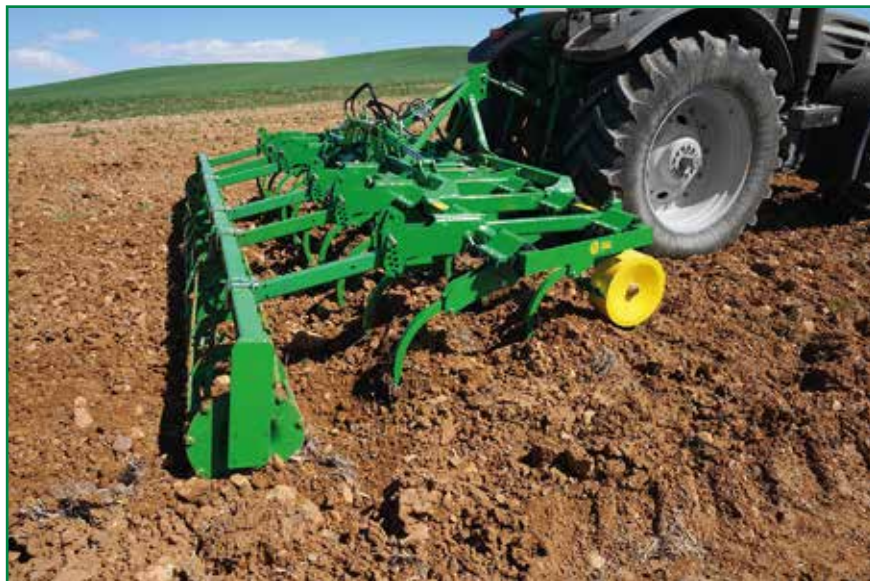
Cultichisel de elastómeros sin mantenimiento, fabricado en chasis de alto límite elástico y con brazos de 35x35 de gran despeje.
