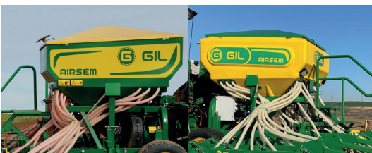
Tolva en chapa o en polietileno. Trémi en tôle ou en polyéthylène. Hopper in sheet metal or polyethylene.
