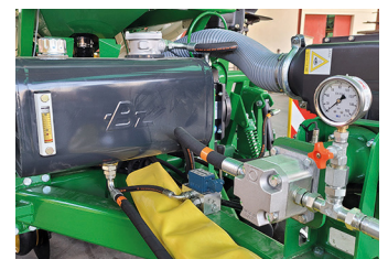
Sistema neumático con transmisión hidráulica independiente y radiador.
