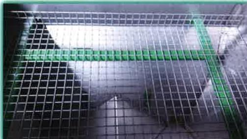
**La tolva fabricada en acero inoxidable con criba asegura una larga durabilidad, independientemente del producto empleado.**
