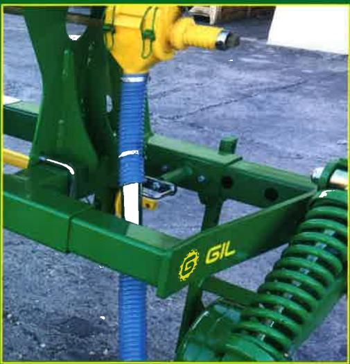
**Ancho de trabajo modificable de 10 en 10 cm, con cerrojo de seguridad por bulón.**
