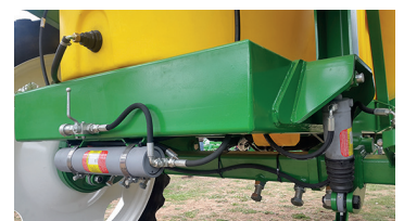
Suspensión Hidráulica en el eje. Suspension hydraulique sur l'essieu. Hydraulic axle suspension.
