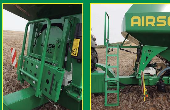
Cómodo acceso a la tolva con el despliegue de la escalera quedando totalmente plegada cuando no sea usada y así evitar que entorpezca durante la maniobrabilidad de la máquina.
