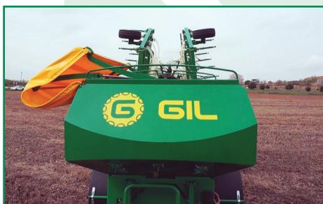
La tolva tiene una capacidad de hasta 6.300L de capacidad y para la opción combinada un 60% semilla y un 40% abono. Con apertura hidráulica desde la cabina del tractor, facilitando así la carga con pala.
