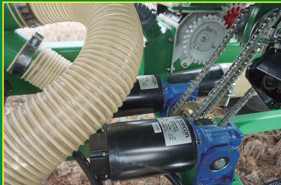
Distribuidor con motor eléctrico para variar la dosis desde el tractor.
