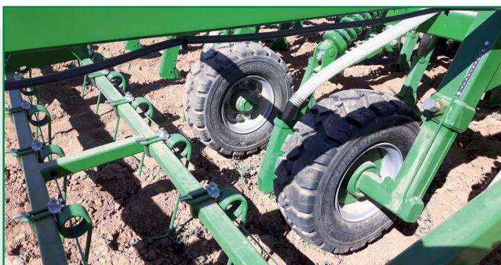
Las ruedas de control traseras en los modelos de siembra directa de reja, permiten el trabajo en cualquier condición del terreno.
