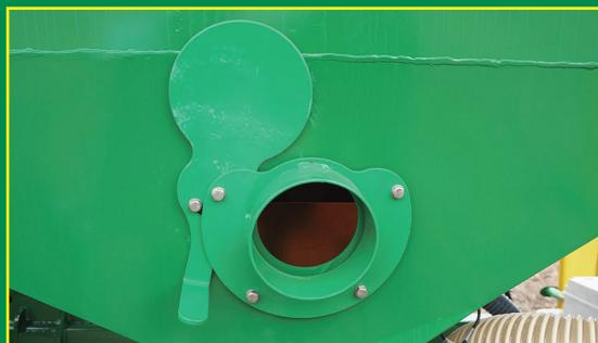
Fácil vaciado, se han dispuesto una o dos bocas laterales, con la posibilidad de acople de una manguera para vaciar el producto de la tolva sin derramarlo al suelo.
