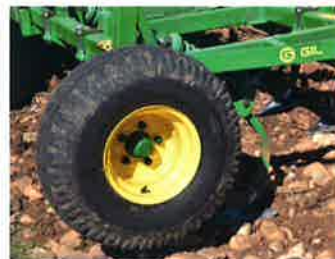
Rueda Neumática 10.0/80-12 Roue pneumatique 10.0/80-12 Pneumatic Wheel 10.0/80-12
