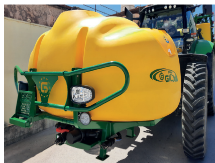
Depósito Delantero 1900 L con peldaño de acceso de serie y focos de trabajo LED (opcional)
