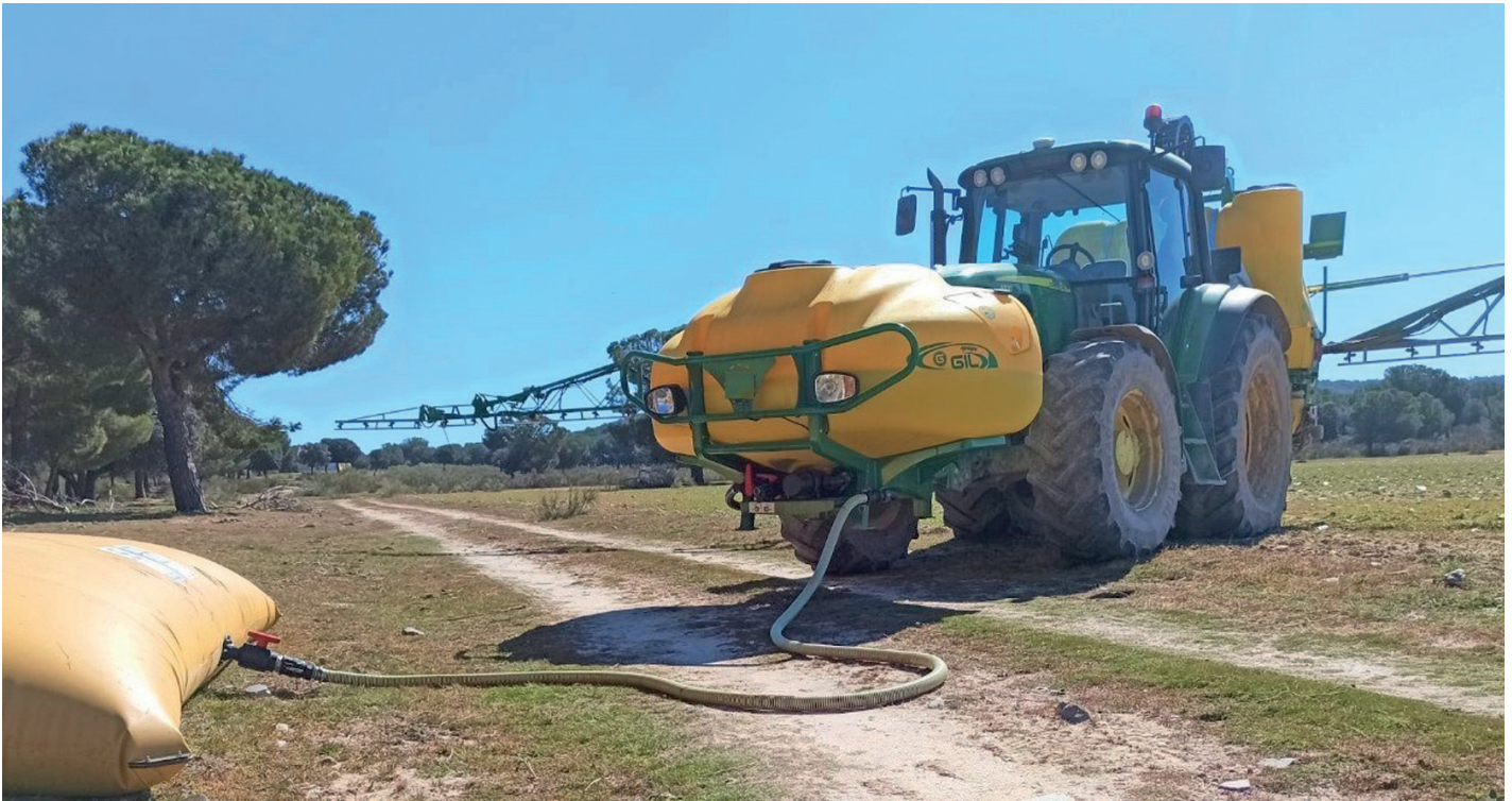
Toma de carga externa con sistema antiretorno
