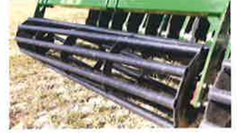
Rulo de barras de 500 mm de serie. Opcionalmente otros tipos de rulos.
