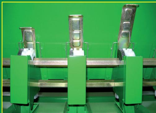
**El distribuidor de doble dentado, le permite sembrar todo tipo de semillas, grandes y pequeñas, con la mayor precisión posible.**
