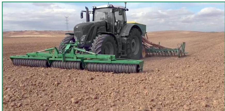
**Nuevos rodillos delanteros GIL modelo RD, es el complemento ideal para la sembradora, al ir asentando e igualando el terreno delante de la misma sin que la humedad se pierda, y permitiendo una profundidad homogénea en todo tipo de siembras, incluso someras. Gracias a su diseño puede ser empleado igualmente como rodillo trasero para las labores posteriores a la siembra.**
