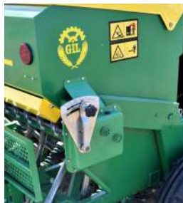
Variador de velocidad.
