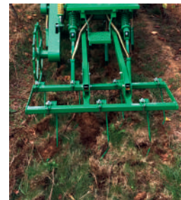
Rastra en 2 filas con distintos tipos de púas (recta, pata ganso y doble).
