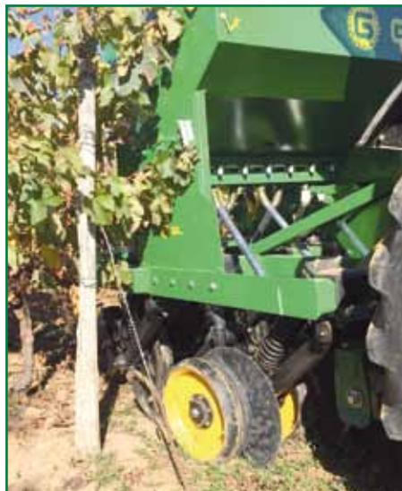
**Un disco simple abridor con una inclinación que facilita la penetración en el suelo, una rueda inclinada para el cierre del surco y una rueda de goma de compactación.**
