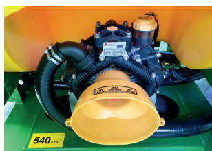
Bomba membrana (apta para abono líquido). Pompe à diaphragme (adaptée aux engrais liquides). Diaphragm pump (suitable for liquid fertiliser).
