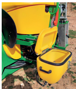
Incorporador de producto con lava envases. Incorporateur de produits avec laveuse de récipients. Product incorporator with container washer.
