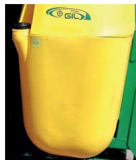
Dépôt auxiliaire. Réservoir auxiliaire. Auxiliary tank.
