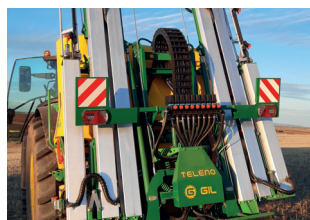
Plegado compacto en transporte. Plie compact avec système de retour. Compact folding for transport.
