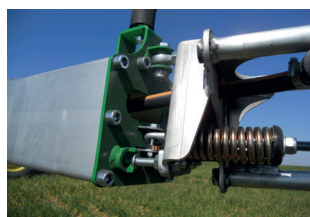
Punteras con sistema de retorno. Embout avec système de retour. Tip with return system.
