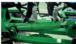
Bloqueo hidráulico + corrector de pendientes. Blocage hydraulique + correcteur de pente. Hydraulic locking + slope corrector.
