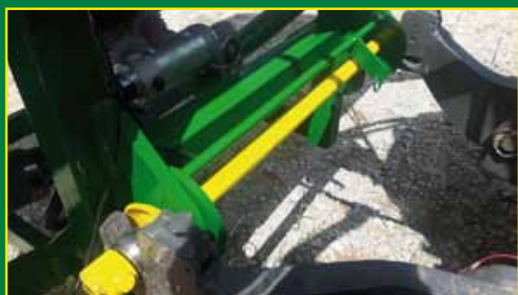
Enganche al tripuntal delantero del tractor.
