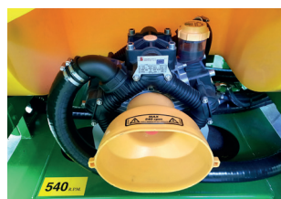
Bomba membrana (apta para abono líquido). Pompe à diaphragme (adaptée aux engrais liquides). Diaphragm pump (suitable for liquid fertilizer).
