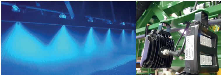
Luces LED azul de trabajo en barra (IP 69K). Feux de travail à LEDs bleues sur la barre (IP 69K). Blue LED working lights installed on the bars IP.
